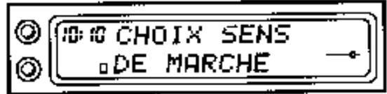
Cet écran apparaît dès que l'UCL passe en "**mode dégradé**" de la commande de sens de marche et, en parallèle, le témoin
