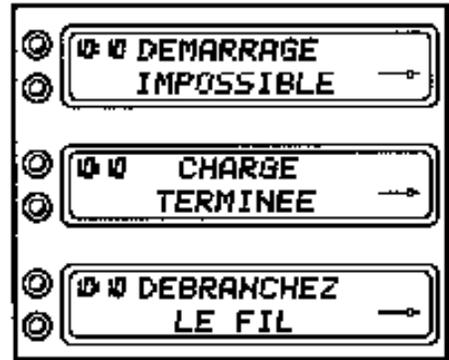
En cours d'affichage d'un de ces messages, un appui sur le contacteur (A) de la planche de bord permet le passage à l'écran suivant de la boucle de l'ordinateur de bord.
