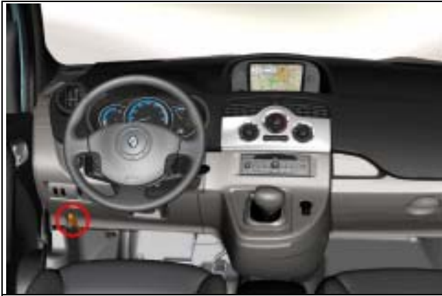
Commande d'ouverture du capot dans l'habitacle
