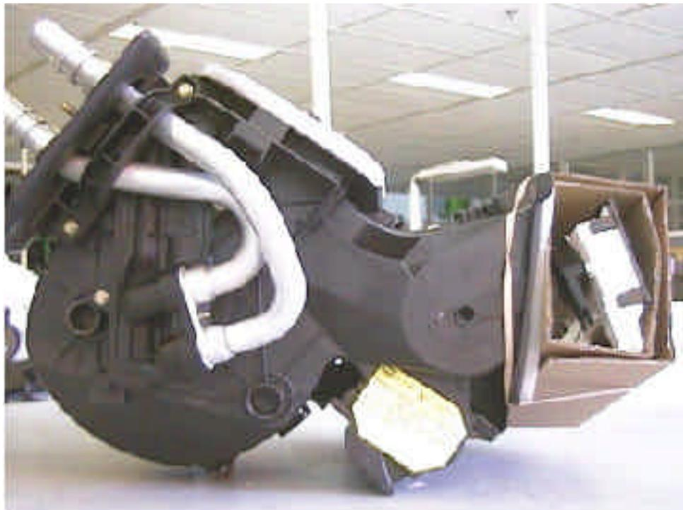
Sur le RACV, les deux tubulures aérotherme ont un diamètre de 18 mm tandis qu'un embout est en retrait, cette modification n'apparaît pas sur cette photo.
