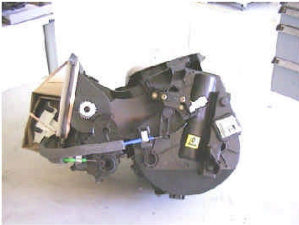
NB : sur cette photo, le plot de fixation et les nervures au bas du connecteur de RCTP prévues pour la fixation et l'appui du capot de protection connecteur spécifique sont manquantes.
