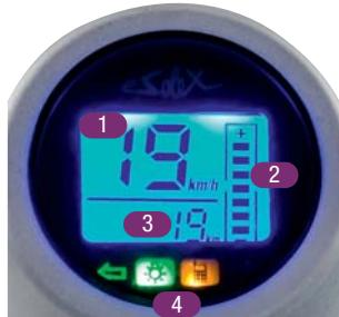
**Met het controle-lampje voor de batterijspanning** op de meter kunt u uw reisweg bepalen. Als de batterij helemaal is opgeladen, lichten de 7 lichtbalkjes op. Tijdens het rijden zullen ze geleidelijk uitgaan. Elk lichtbalkje staat voor ongeveer 15% van de batterijspanning. Wanneer er veel van de batterij gevergd wordt, zoals op een helling, kunnen sommige lichtbalkjes op hetzelfde ogenblik uitgaan;
