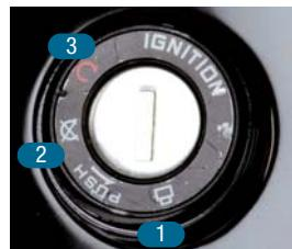
Pour déverrouiller la batterie, couper le contact en passant de la position 3 à la position 2 puis enfoncez légèrement la clé pour passer en position 1. Les 3 serrures de votre **e-Solex** fonctionnent avec la même clé livrée en 2 exemplaires.
