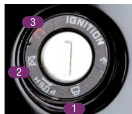
Om de batterij te vergrendelen, moet u de motor uitzetten door van stand 3 naar stand 2 te gaan en dan de sleutel lichtjes in te drukken om naar stand 1 te gaan.
